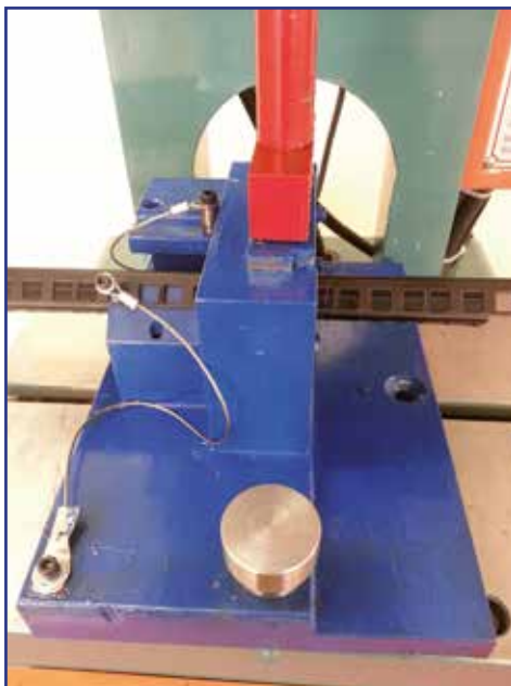
Exaktes Schneiden von Stahl-Rackschienen oder Scharnierband. Precise cutting of steel rack rails or piano hinges.
